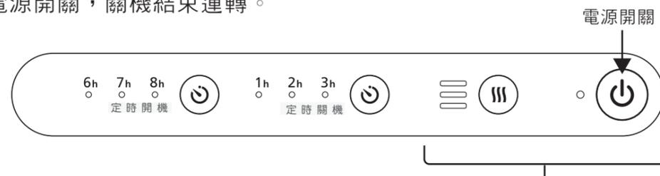
電源開關LED、暖房能力切換LED、通電指示LED皆熄燈。
