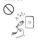
如果拉扯電源線有可能損 壞電源線導致短路、火災 或觸電。
