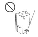
這樣可能會造成短路或損 傷電線内部的導線,並可 能導致火災或觸電。
