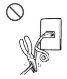
放置重物、加熱、拉扯所產 生的破損,可能導致火災或 觸電。
