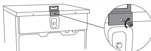
**3** 用螺絲將傾倒防護器 (B部分) 固定到洗衣機背面。
