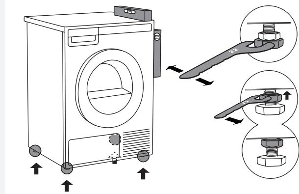
平穩安放乾衣機。使用水平儀橫縱向對準乾衣機，使用22號扳手(最大15mm)旋轉調節支腳。然後，用17號扳手擰緊機器底部螺母(鎖緊螺母)穩固機器↑。
