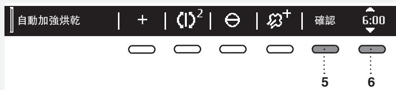
按下6鍵顯示箭頭圖示，使用程式選擇旋鈕或6鍵設定預約時間，以30分鐘為單位從30分鐘到6小時，以1小時為單位從6小時到24小時。
