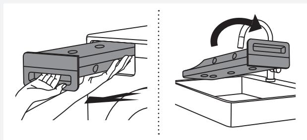
**1** 從乾衣機拉出冷凝水箱，在盥洗盆、洗滌槽或其他尺寸合適處將上方翻轉過來。
