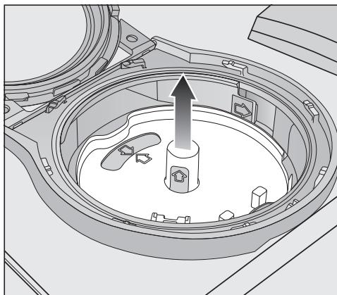
■ 利用黃色突塊向上拉動 PowerDisk 固定器並將其取出。在進行此項操作時，請勿拉動側邊突塊。
