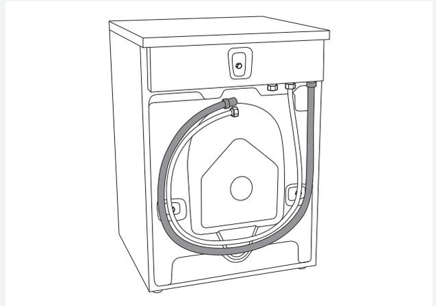
本機送貨時隨附排水軟管，必須將其連接下水管道，也可以連接到裝有疏水閥的牆面排水管，疏水閥應正確安裝以允許清潔。排水管道可高於洗衣機安放地面 600–900 mm，最好置於較低位置 (600 mm)。確保排水軟管未被夾住或彎曲。
