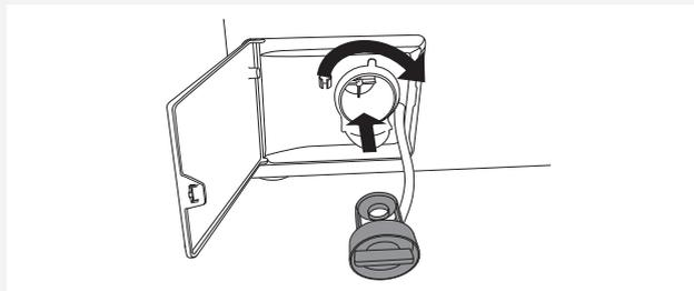
**6** 如圖放回濾篩，按順時針方向旋轉固定。為了良好的密封，濾篩密封表面應清潔。同時重新安裝排水管。
