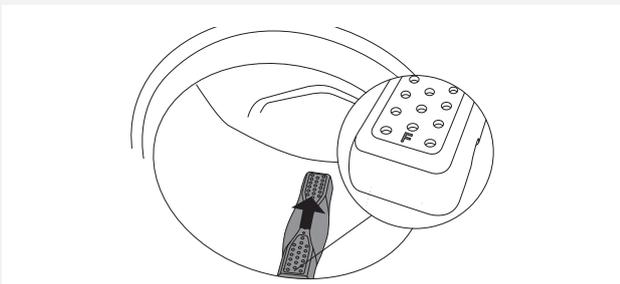
**5** 將葉板“F”標誌的方向朝自己，放入安裝槽穴內。確認所有葉板都牢固地嵌入各自的槽穴中。將葉板向內推 (如圖中箭頭所示) 直到發出卡住音效。
