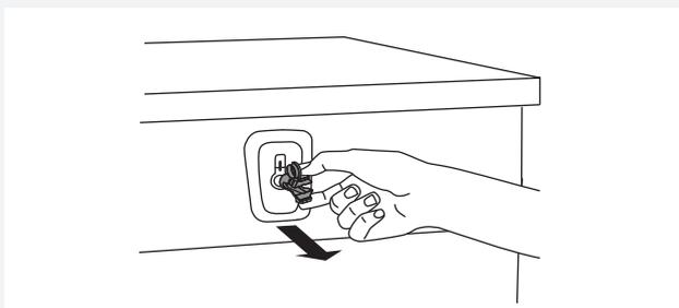
**2** 先擠壓再拉出，拆下固定螺絲的塑膠塞。
