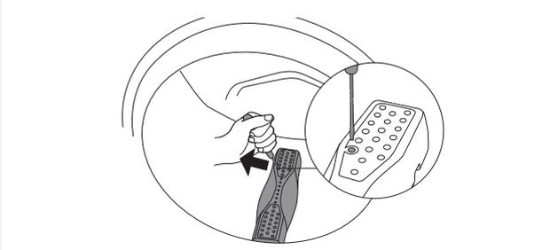
**1** 將螺絲刀或類似工具插入葉板的槽孔中，並小心地向左推。
