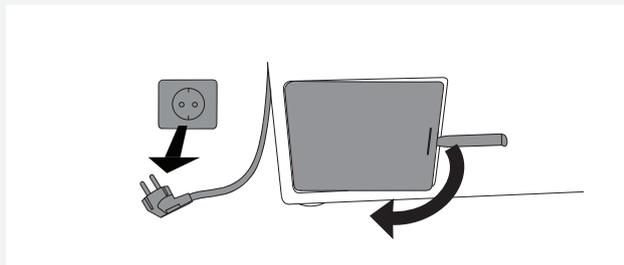
**1** 清潔之前首先用排水程式排乾洗衣機內的水，從插座上斷開洗衣機電源。
