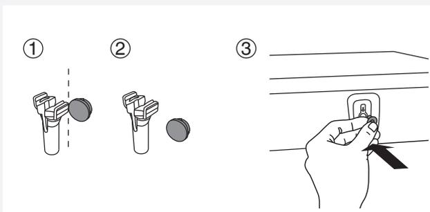
**3** 從塑膠塞上取下蓋子。將蓋子推回三個插入塑膠塞的孔中。若您以後需運輸洗衣機，請保留螺釘和塑膠塞。
