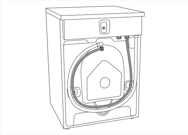
進水管必須非常緊固地連接，使軟管具有良好的密封性。
