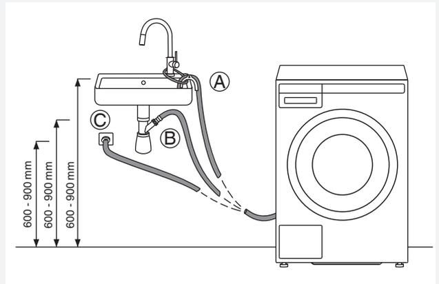
排水軟管也可以通過虹吸管直接連接到洗臉盆排水管。在這種情況下，軟管也應該在地板上方 600–900 mm。軟管內徑應至少為 18 mm。見圖示。
