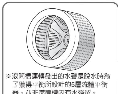
※ 滾筒槽運轉發出的水聲是脫水時為了獲得平衡所設計的5層流體平衡器，並非滾筒槽內有水殘留。
