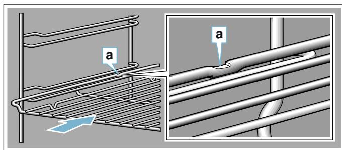
安裝烤盤時，請確保耳狀凹槽 **a** 位於後方並面朝向下。配件的斜邊 **b** 必須朝向電器箱門。
