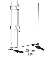
可以通過扭轉調平地腳來從前面 調整冰箱的高度。
