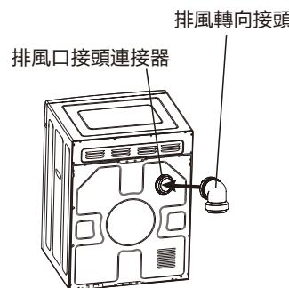
2. 將排風轉向接頭順時針方向旋轉，使其旋入排風口接頭的卡槽內，排風轉向接頭不可朝上裝置。
