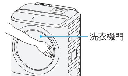
否則直接運轉或設定兒童安全鎖時，將出現「C03」錯誤顯示。〈46、47頁〉出現「C03」錯誤顯示時，請按圖示滑動防止鎖門按鈕，然後確實關好洗衣機門，按「起動」按鈕，可以鎖定洗衣機門開始運轉。
