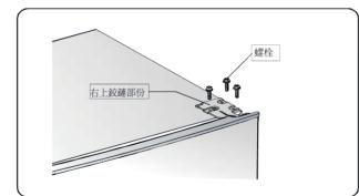
3. 移除上鉸鏈軸，轉到相反的方向並牢固擰緊，放在安全的地方。
