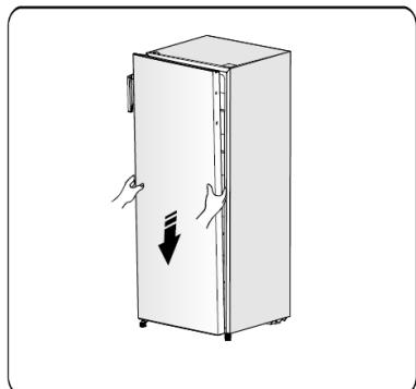
9. 將上鉸鏈軸插入上門處的洞, 並調整門的位置(請用手支撑住門體), 並且用螺絲固定住上鉸鏈。
