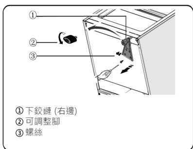
7. 將下鉸鏈部分裝回左側並用螺絲固定。將水平調節腳對換位置安裝並固定。
