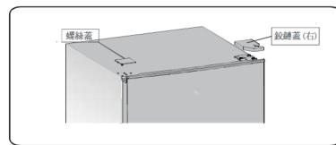
2. 以 8mm 六角套筒扳手或扳手拆下固定右上鉸鏈部份的 3 個螺絲，請用手支撐著上門。
