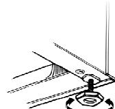
附註：若需移動冰櫃，請將水平調整腳向右轉，直到水平調整腳未與地面接觸為止。如此一來，就能更輕易地移動冰櫃。
