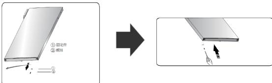
6. 將產品放在包裝泡沫或相似的材料上。移除兩端的水平調節腳, 移除螺絲將下鉸鏈拆除。
