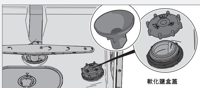
取下保護蓋並在容器中裝滿軟化鹽。只有第一次使用機器時需要加水。擦拭乾淨並鎖緊蓋子。執行洗程確認已沖走洗碗機中的軟化鹽。
