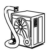
您的烘衣機必須配備通風管(如果沒有配備,可選擇可用配件)。 通風管可將濕熱空氣從烘乾機機後部排到室外。
