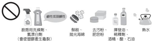
※ 使用上述液體擦拭時，可能會造成金屬腐蝕，印刷脫落或部品異常現象發生。
